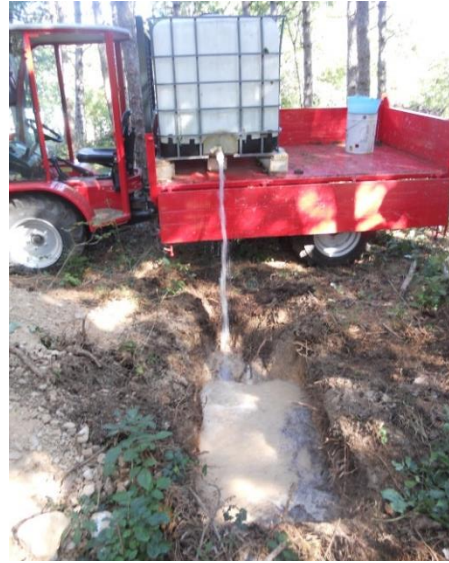
Figura 16: fasi esecutive prova di permeabilità nella trincea T4
