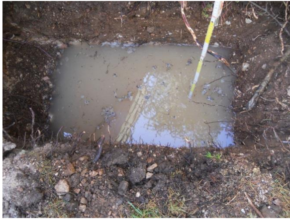
Figura 15: fasi esecutive prova di permeabilità nella trincea T2
