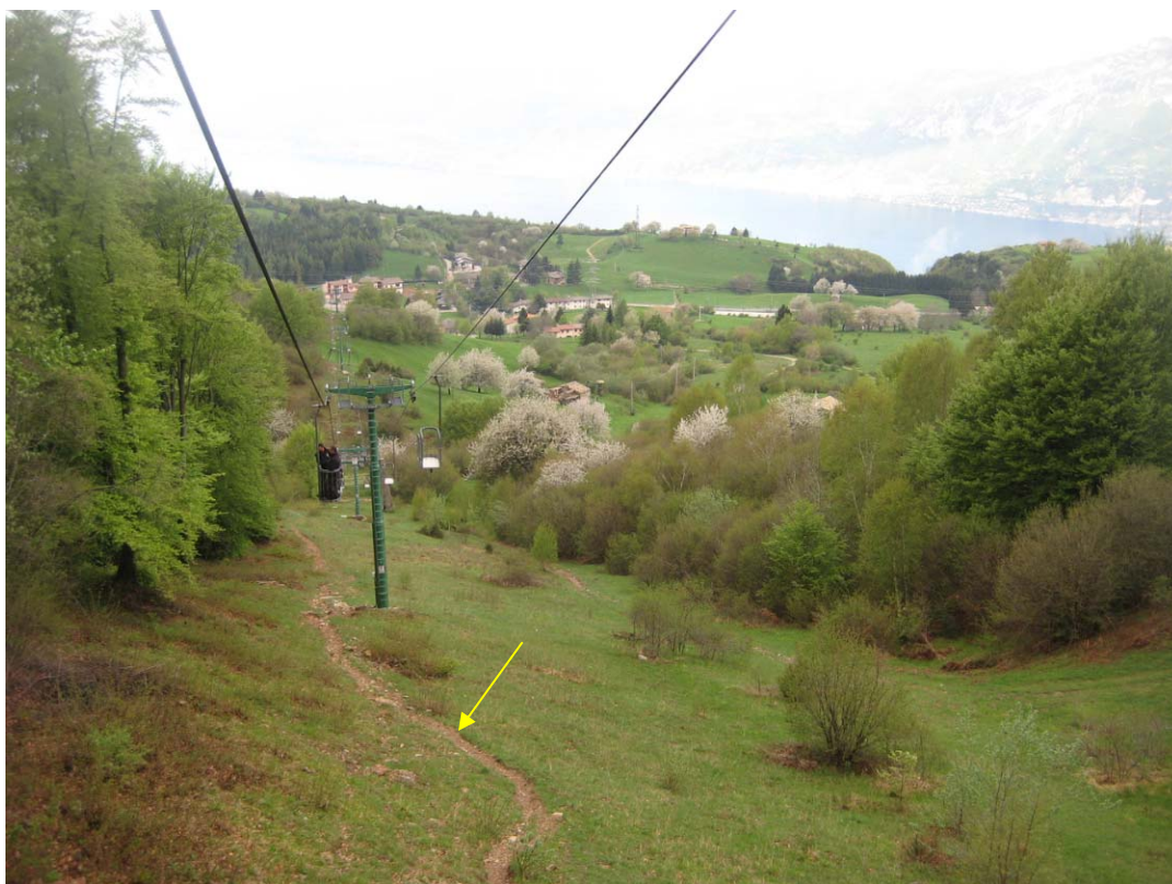
Foto 1: parte medio-bassa del tracciato; lungo i sentieri affiora il terreno di copertura eluviale a matrice sabbioso-limosa marrone-rossiccia (freccia).
